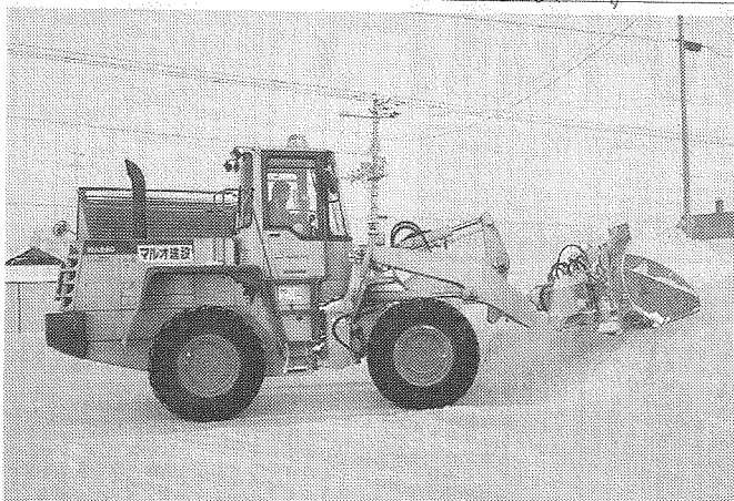
BDFを使う除雪車。気温が零下20度以下になる旭川市内で試験を始めた
